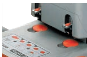
Wymienne dyski dociskowe umożliwiają precyzyjne wykrwanie otworów w całym stosie dokumentu i zabezpieczają ostrza dziurkacza.
